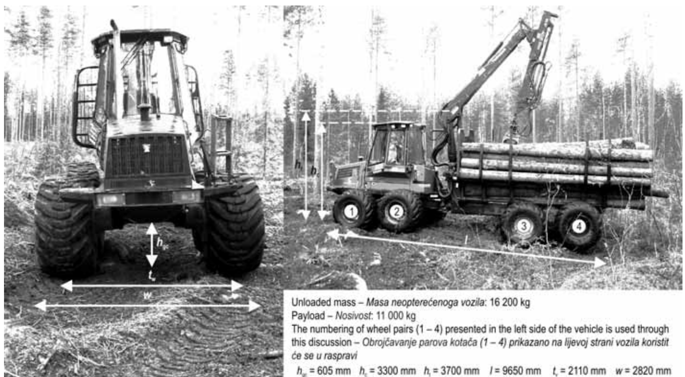
Fig. 1 Dimensions of the test forwarder Slika 1. Dimenzije ispitivanoga forvardera
