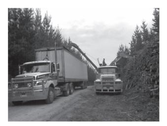
Fig. 2 Morbark chipper and chip van Slika 2. Iverač Morbark i kamion za prijevoz drvne sječke
