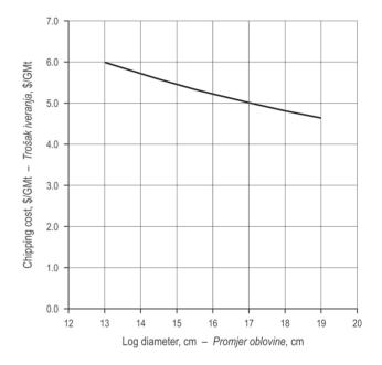
Fig. 5 Impact of log diameter on chipping cost *Slika 5. Utjecaj promjera oblovine na trošak iveranja*
