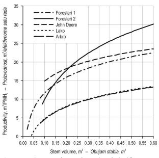
Fig. 1 Net productivity as a function of stem volume, for the different tests *Slika 1.* Neto proizvodnost u ovisnosti o obujmu debla za različite studije
