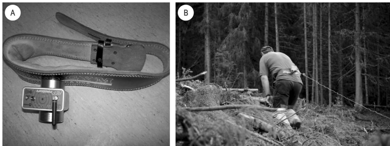
Fig. 2 Illustration of the belt, dynamometer (A) and steel strawline being pulled out (B) Slika 2. Prikaz remena, dinamometra (A) te izvlačenja čeličnoga pomoćnoga užeta (B)
