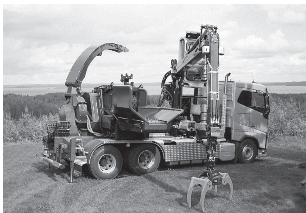
Fig. 9 Hybrid wood chipper Kesla C 860 H ( https://www.kesla.fi )
